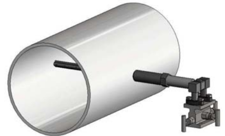
Abbildung 1 DF12 für horizontale Rohrleitung mit Schneidringstutzen und Dreiwegeblock
